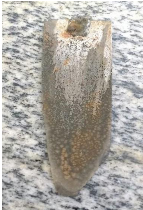
Figura 20: Corrosão no eletrodo.
