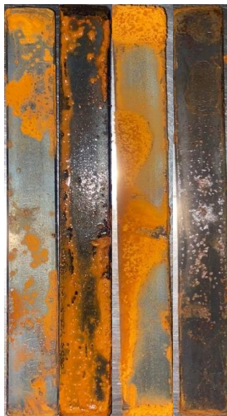
Figura 12: Corrosão no meio neutro no aço carbonico com 15, 30, 45 e 60 dias de experimento.
