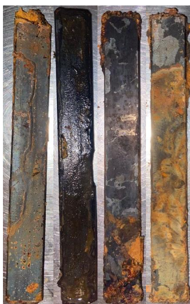
Figura 13: Corrosão no meio ácido do aço carbonico com 15, 30, 45 e 60 dias de experimento.
