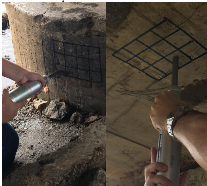
Figura 18 – Esclerômetro sendo aplicado horizontalmente e verticalmente, respectivamente
