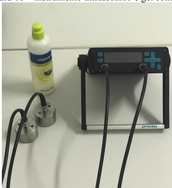
Figura 16 – Instrumento ultrassônico e gel condutor
