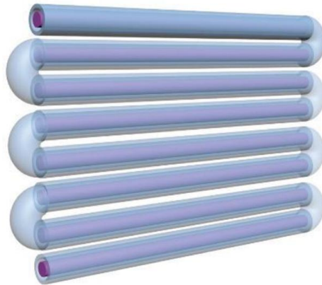
Figura 12 - Geometria da montagem serpentina de reatores anulares de filme fino em lama para tratamento fotocatalítico de água
