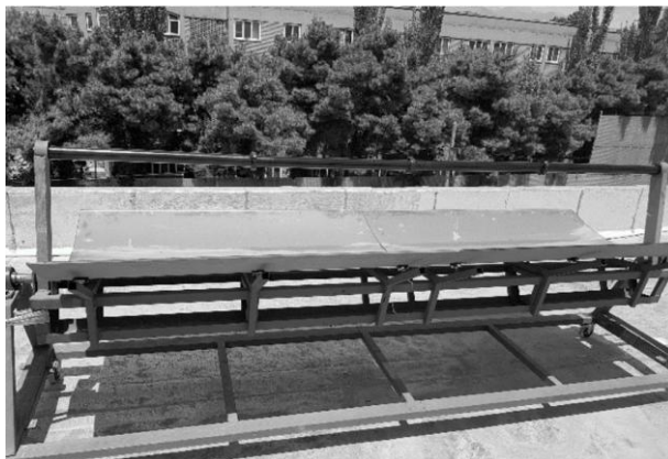
Figura 18 - O coletor solar de calha parabólica embutido construído
