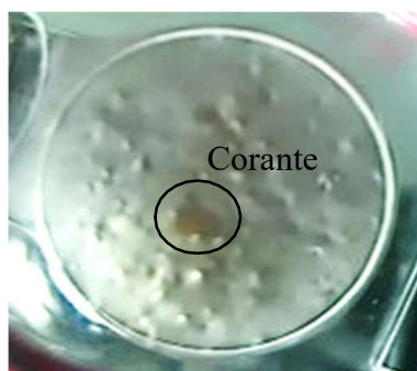
Figura 25 - Face inferior da amostra MP/15 kg, após ensaio de molhamento.
