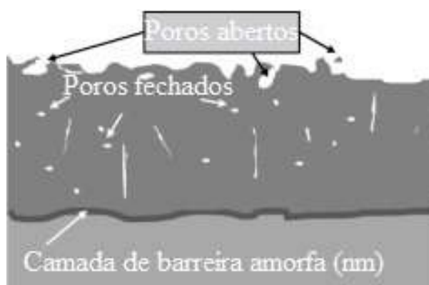
Figura 5 - Ilustração das camadas do revestimento PEO.
