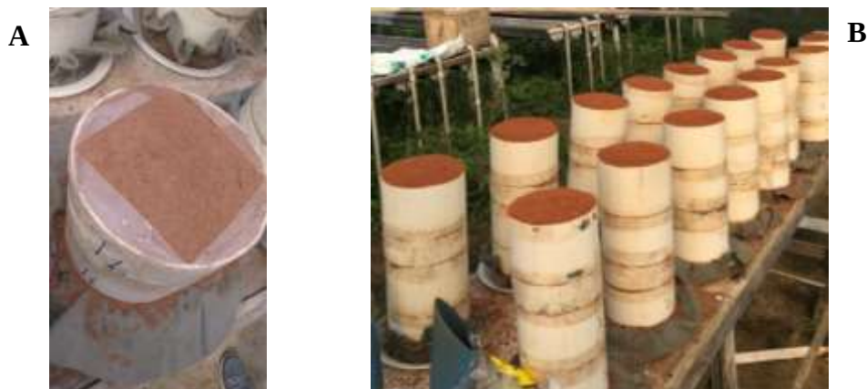
Figura 2. Colunas de solo montadas (A) e fitas plásticas (B) colocadas para evitar o crescimento das raízes do feijão-caupi contíguas à parede do tubo.
