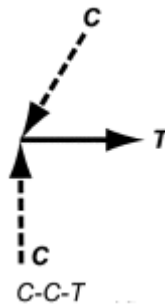
Figura 6.3: Representação do tipo de nó do apoio analisado
