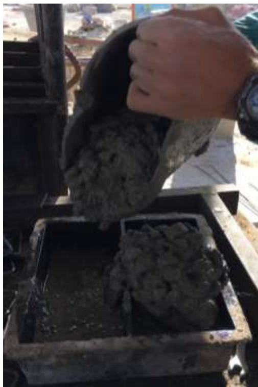
Figura 18 - Preenchimento das formas com concreto.
