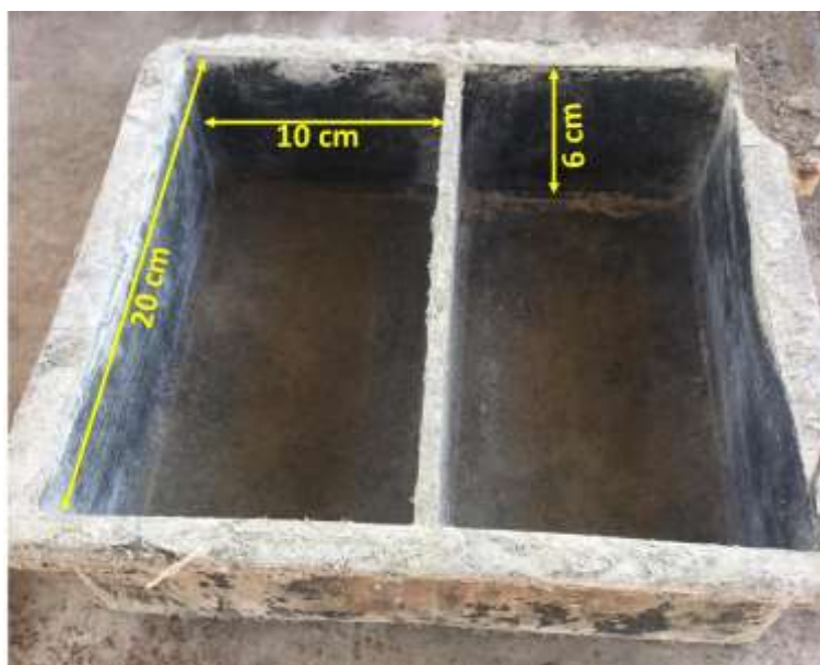
Figura 11 - Formas usada no processo de fabricação.
