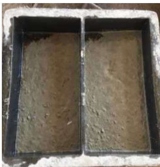
Figura 16 - Argamassa na base da forma.
