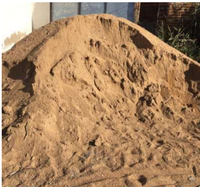
Figura 13 - Agregado miúdo usado na fabricação dos blocos intertravados.
