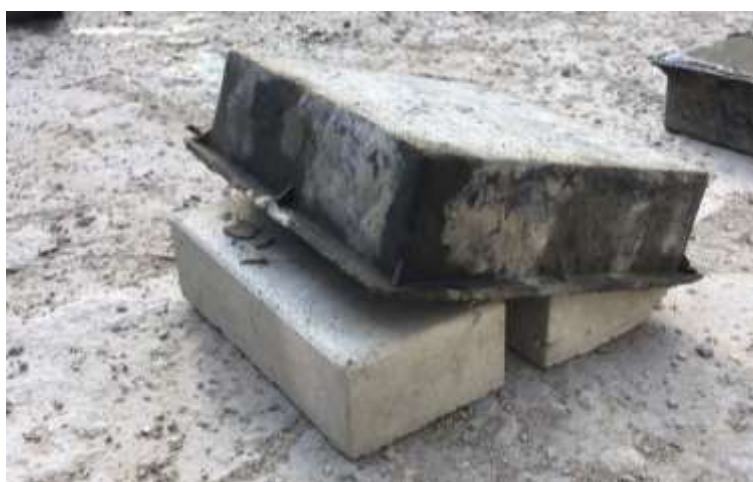
Figura 21 - Desmoldagem dos blocos.
