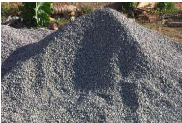
Figura 14 - Agregado graúdo usado na fabricação dos blocos intertravados.
