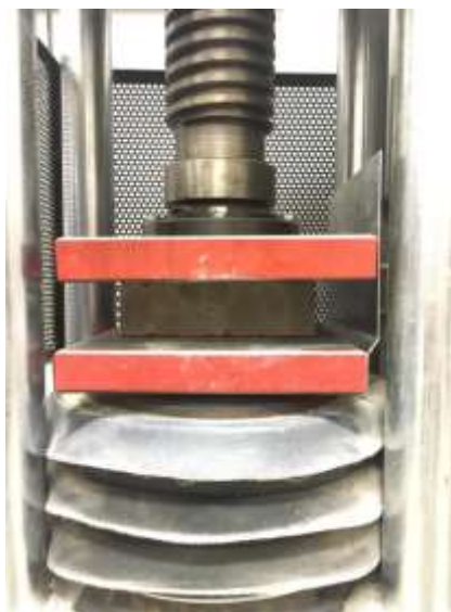
Figura 23 - Ensaio de compressão do bloco.
