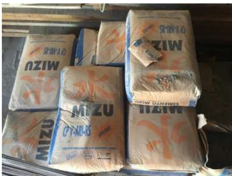
Figura 12 - Cimento usado na fabricação dos blocos intertravados.
