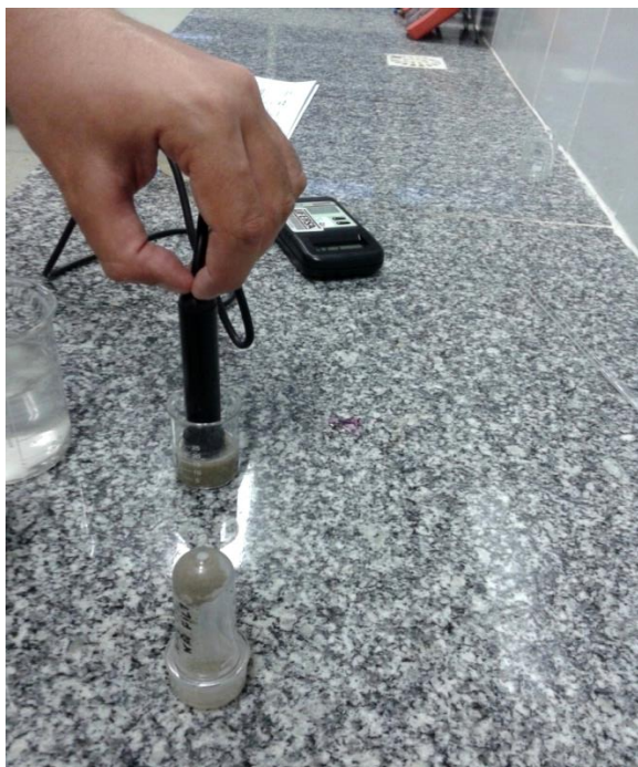
Figura 3. 9: Medição da condutividade elétrica das amostras
