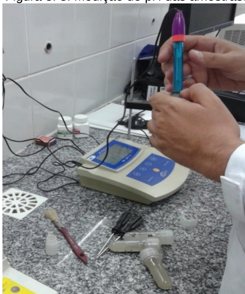
Figura 3. 8: Medição do pH das amostras.
