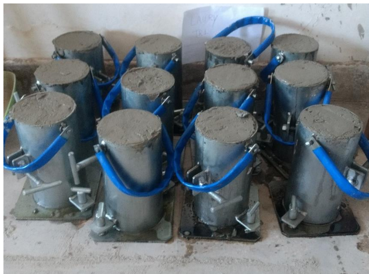
Figura 6 – Corpos de prova após moldagem.
