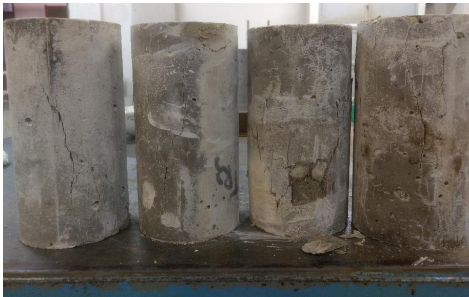
Figura 9 – Corpos de prova após ensaio de compressão axial.
