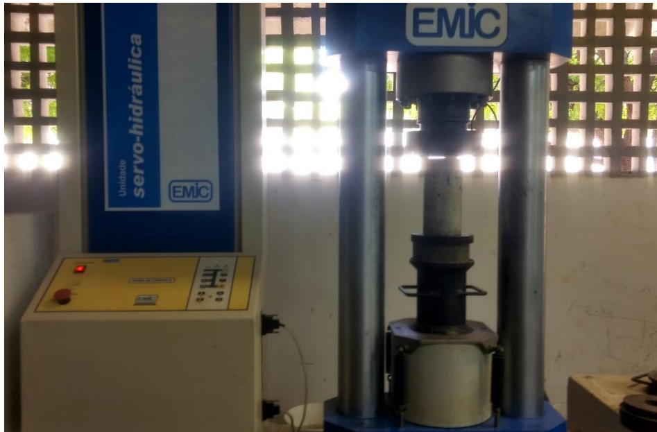
Figura 7 – Prensa utilizada para ensaio de compressão axial.
