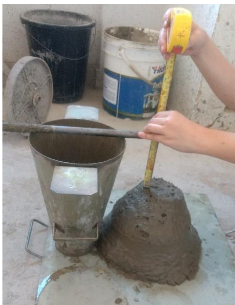
Figura 5 – Ensaio de tronco de cone.
