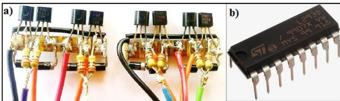
Figura 14: Tipos de ponte H: a) construída a partir de materiais discretos; b) formato de circuito integrado.
