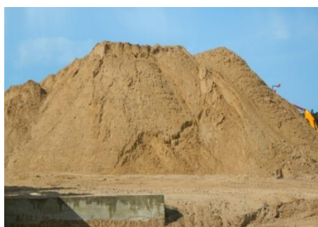
Figura 9a – Areia utilizada em construções
