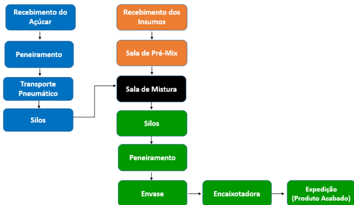
Figura 2 Fluxograma simplificado do processo de produção do refresco em pó Frisco e Tornado.
