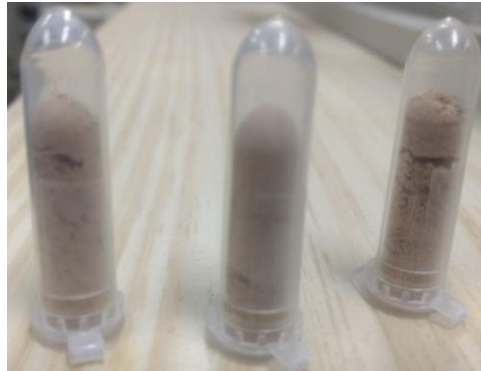
Figura 8: Amostras para os ensaios de fluorescência de raios X.
