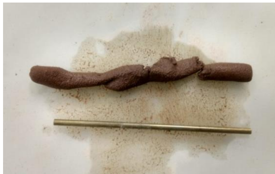
Figura 25: Resultado do ensaio de limite de plasticidade.
