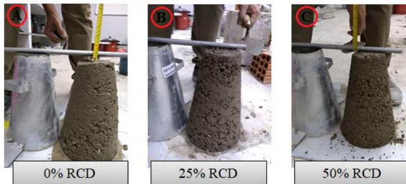
Figura 27: Resultado visual do ensaio de Slump test
