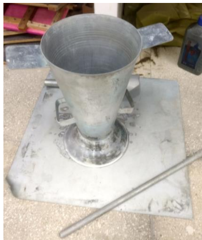
Figura 21: Equipamentos utilizados no Slump test .
