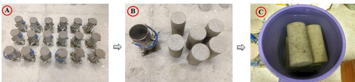
Figura 19: Desmoldagem e cura do concreto.
