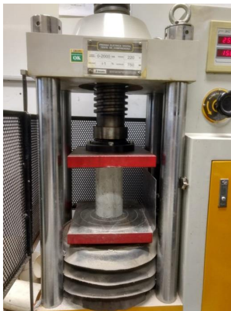
Figura 23: Ensaio de resistência à compressão.
