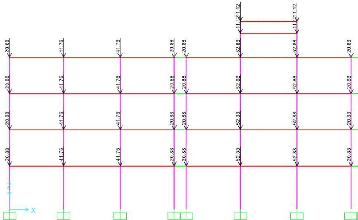
Figura 24: Carga concentrada devido a laje steel/ deck
