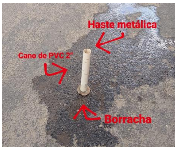
Figura 16: Ensaio de Drenabilidade
