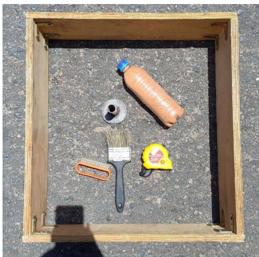
Figura 15: Ensaio de Mancha de Areia
