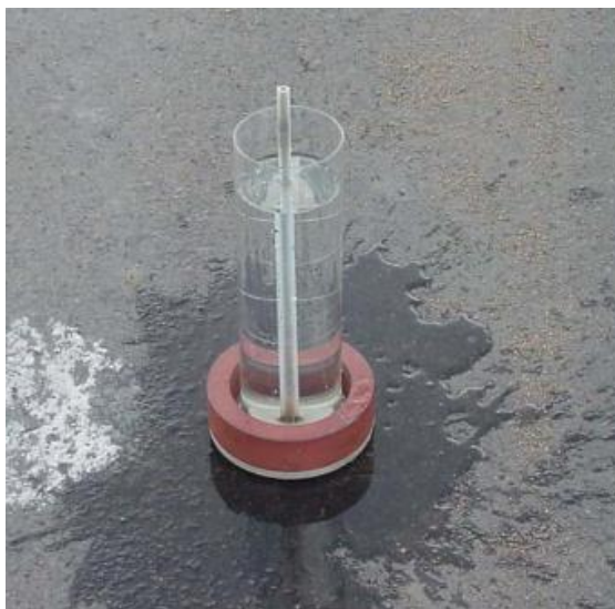
Figura 8: Ensaio de Drenabilidade
