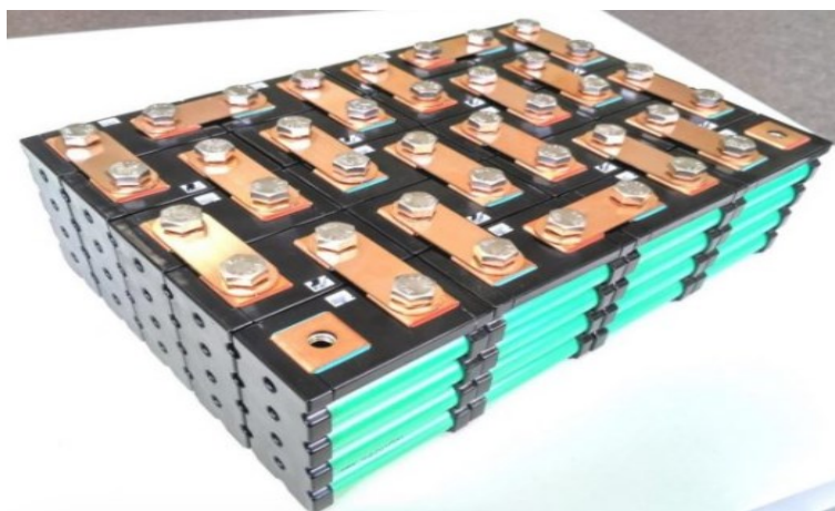
Figura 6 – Módulo de baterias de íons de lítio formado pela associação de células em série.
