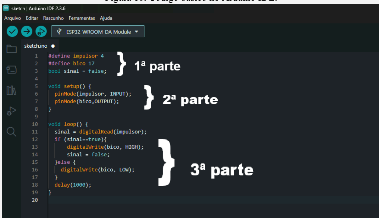
Figura 10. Código básico no Arduino IDE.
