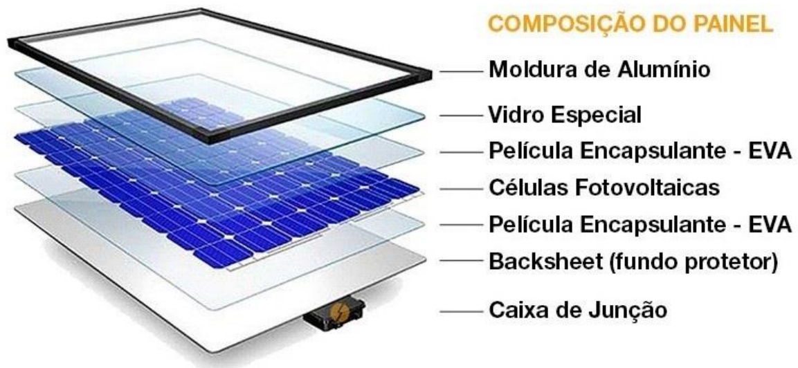
Figura 3 – Camadas constituintes de um painel solar padrão
