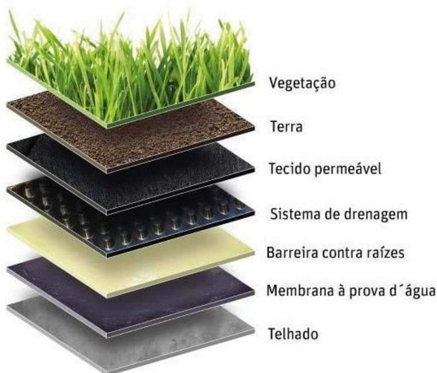
Figura 12 – Partes constituintes de um telhado verde standardizado.
