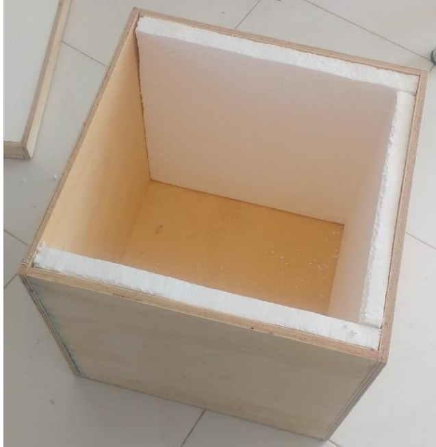
Figura 6: Montagem das placas de isopor laterais.
