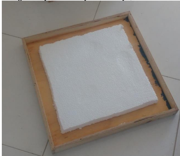
Figura 9: Montagem de placa de isopor na tampa, com acabamento.
