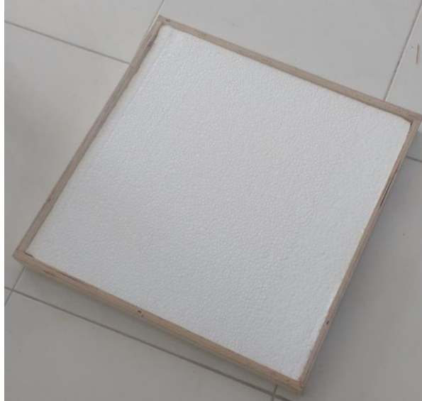
Figura 8: Montagem de placa de isopor na tampa, sem acabamento.
