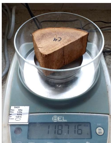
Figura 24 - Pesagem do conjunto composto por madeira úmida e cápsula
