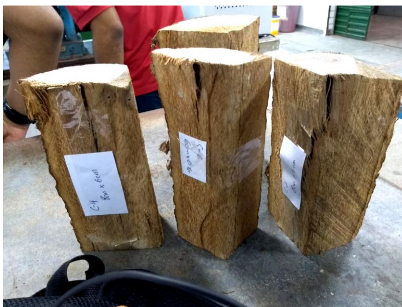
Figura 30 - Corpos de Prova após sofrer Ruptura por Compressão Axial
