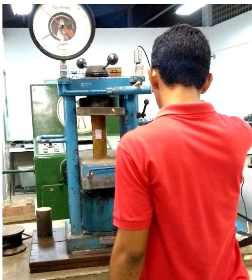
Figura 29 - Corpo de Prova submetido à Compressão Axial
