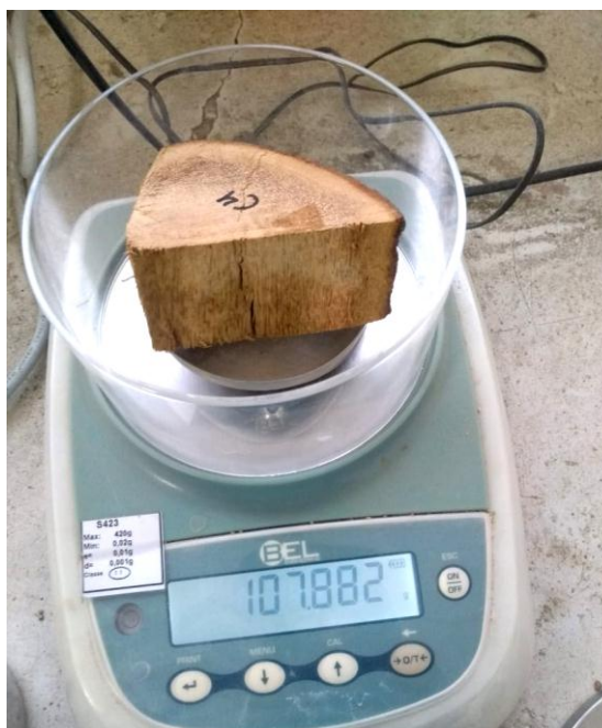
Figura 26 - Pesagem do conjunto composto por madeira seca e cápsula
