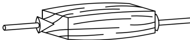
Figura 9 – Compressão Axial Paralela às Fibras
