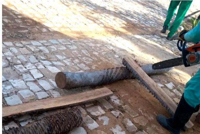
Figura 18 - Quarteamento da Tora da Carnaúba com auxílio de um Motosserra
