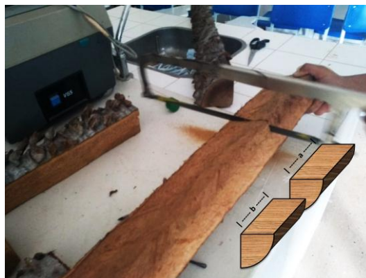
Figura 20 - Definição dos comprimentos dos Corpos de Prova com uma Serra de Mão
