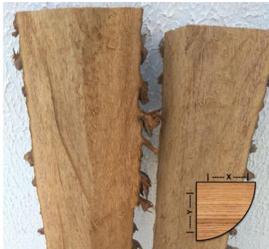
Figura 19 - Tora quarteada com seção em formato de Quarto de Elipse
