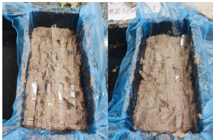
Figura 7 – Tijolos com camadas de PET
