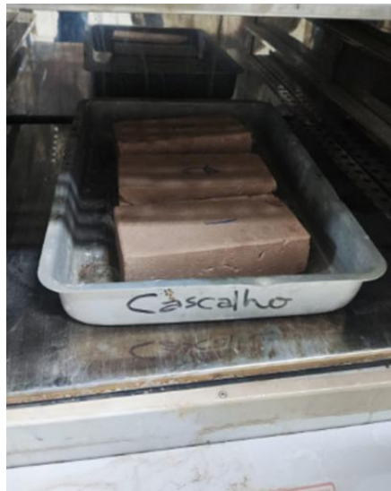
Figura 6 – Tijolos seco em estufa.
