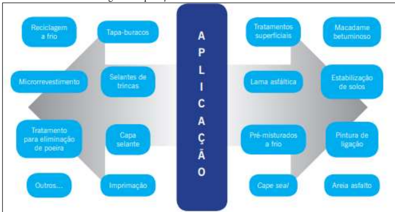
Figura 7: Aplicações da emulsão asfáltica.
