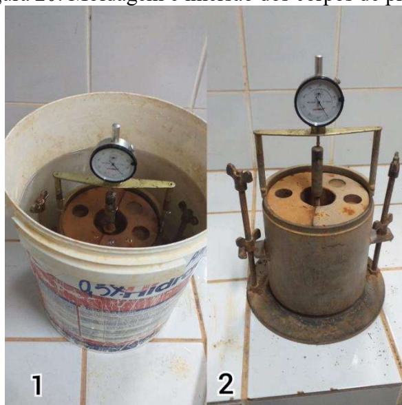
Figura 20: Moldagem e imersão dos corpos de prova.
