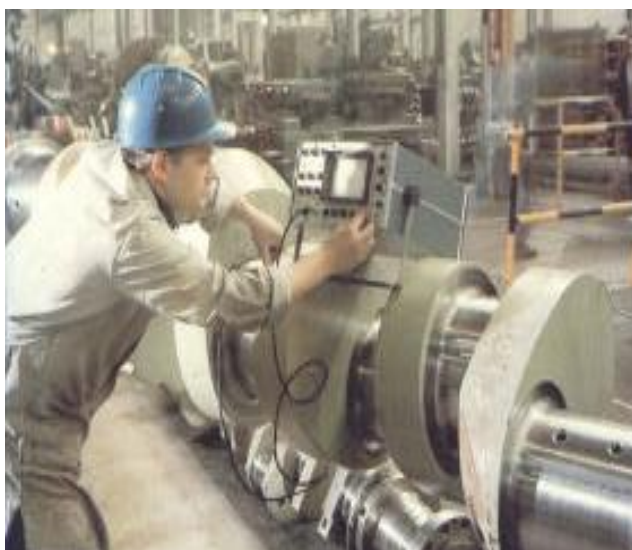
Figura 4 – Inspeção por ultra-som Fonte: (Andreucci, 2002)
