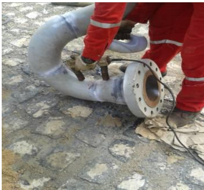
Figura 3: Ensaio de Partícula Magnética utilizando a magnetização por Yoke eletromagnético.
