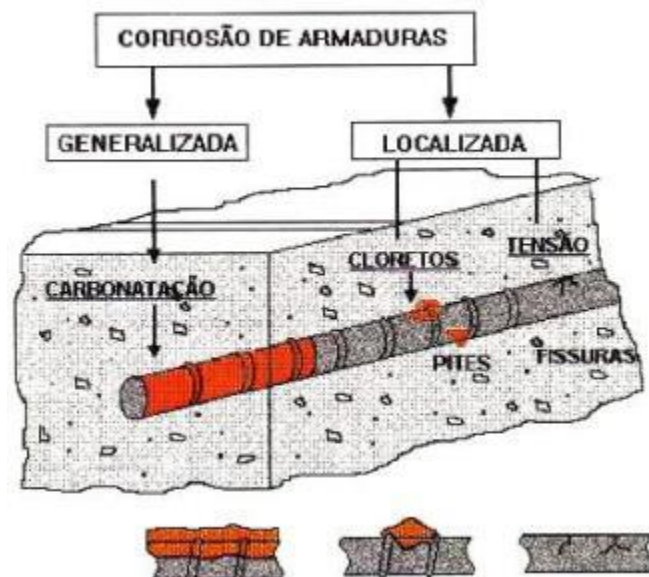
Figura 11: Tipos de corrosão
