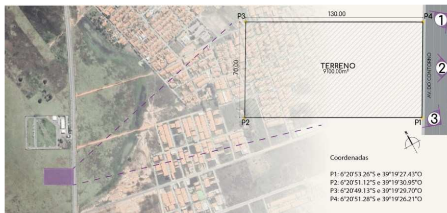
Figura 65 – Terreno ampliado com dimensões, coordenadas e posicionamento fotográfico.
