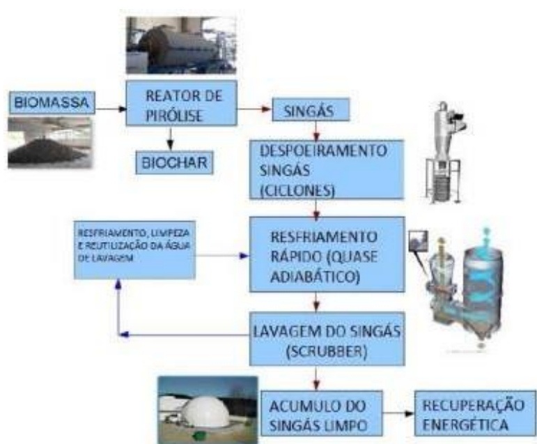
Figura 10- Processo da planta de pirólise da Innova Energias Renováveis.
