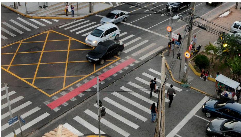
Figura 20 – Marcas transversais associadas entre si
