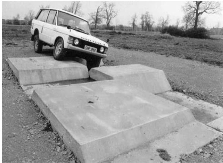
Figura 2 - Torção aplicada ao chassi em terreno irregular
