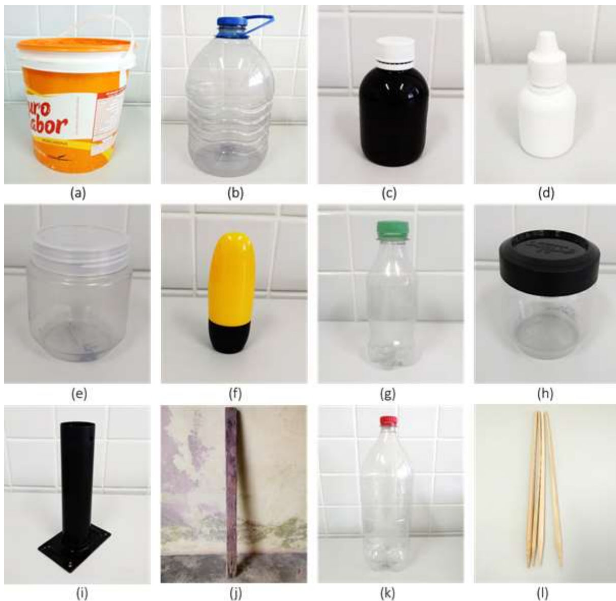
Figura 10 - Materiais reciclados selecionados para a construção do protótipo de pluviômetro automático: (a) Balde de margarina de 3 Kg; (b) Galão de desinfetante 5 L; (c) Frasco de xarope de 100 ml; (d) Frasco de medicamento em gota de 20 ml; (e) e (h) Pote de gel para cabelo de 200 ml; (f) Tubo de roll-on de 30 ml; (g) Garrafa de refrigerante de 250 ml; (i) Suporte para ventilador de parede; (j) Caibro de 1,6 m; (k) Garrafa de refrigerante de 2 L e (l) Palito para churrasco.
