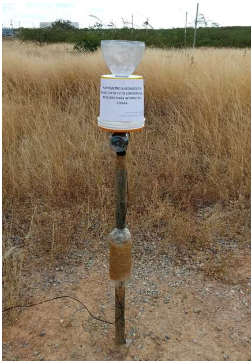
Figura 29 - Pluviômetro automático de baixo custo feito com material reutilizável para a internet das coisas.
