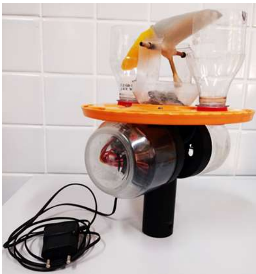
Figura 20 - Suporte com case e circuito acoplado, base e báscula.
