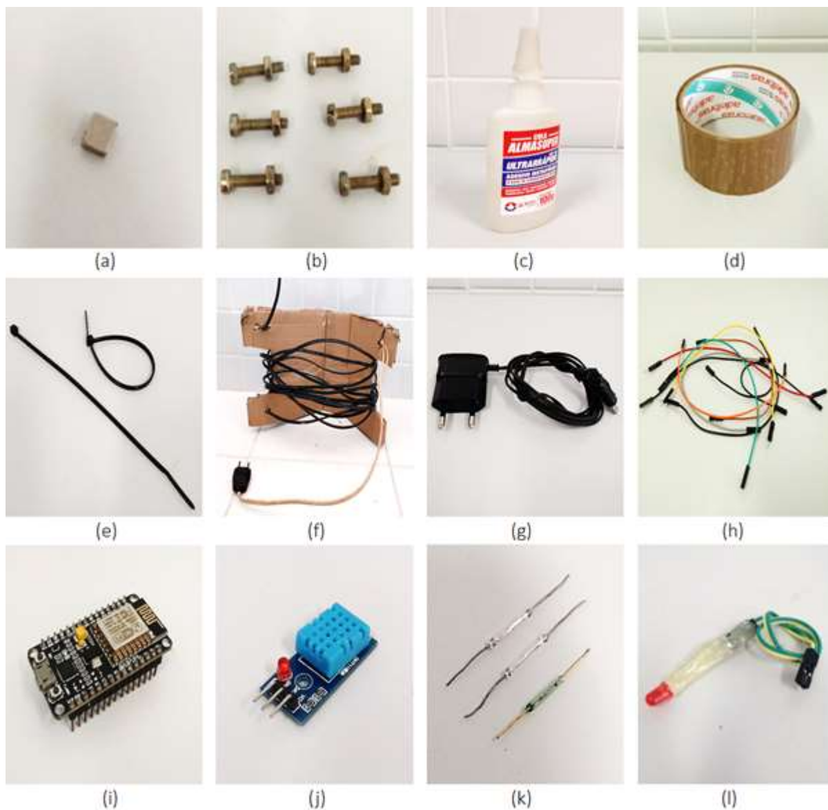
Figura 11 - Materiais complementares para a construção do protótipo de pluviômetro automático: (a) Super ímã de leitor de DVD; (b) Parafusos com porcas de 2 mm de diâmetro; (c) Supercola; (d) Fita adesiva; (e) Abraçadeira de Nylon; (f) Extensão elétrica de 20 m; (g) Carregador para celular micro USB; (h) Jumpers; (i) Módulo WiFi (NodeMCU ESP8266); (j) Sensor de temperatura e umidade (DHT11); (k) Sensor magnético ( Reed switch ) e (l) LED indicador.
