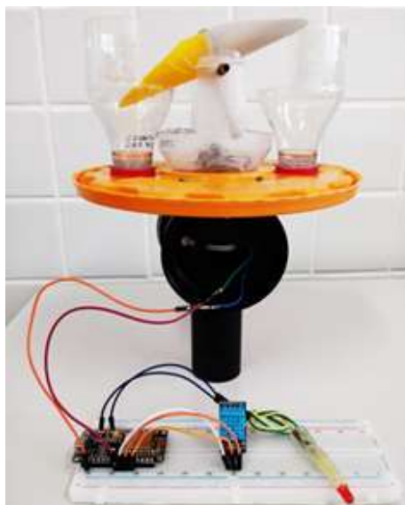
Figura 19 - Teste de funcionamento do circuito e acionamento do sensor magnético.
