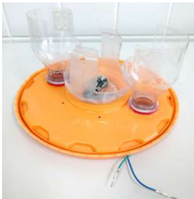
Figura 14 - Base do pluviômetro.
