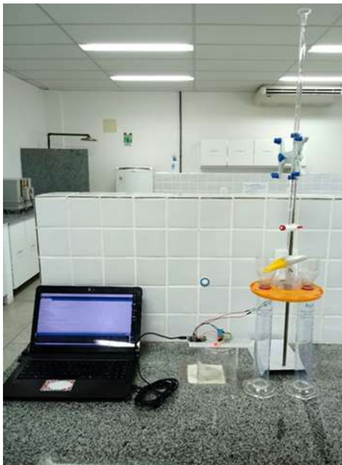
Figura 22 - Calibração do pluviômetro no laboratório.
