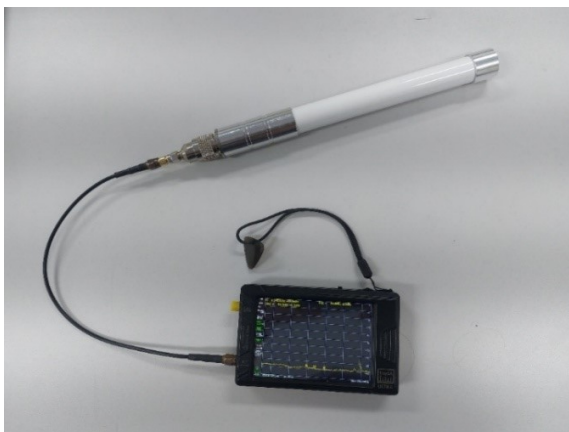
Figura 6 – Analisador de espectro e Antena. (Autoria própria)
