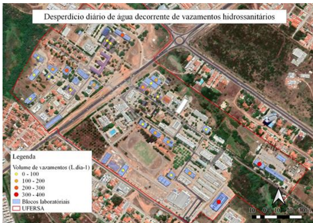
Figura 20: Desperdício diário de água decorrente de vazamentos hidrossanitários
