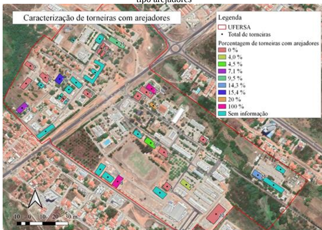
Figura 22: Caracterização de torneiras quanto ao uso de dispositivos poupadores de água do tipo arejadores
