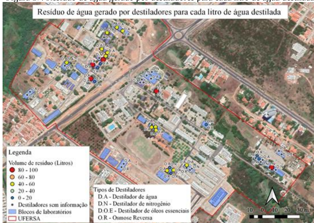
Figura 17: Resíduo de água gerado por destiladores para cada litro de água destilada
