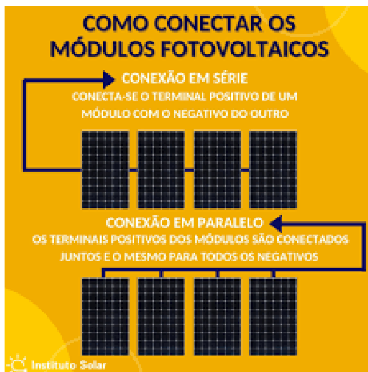
Figura 14: Sistema fotovoltaico conectado em serie ou paralelo.
