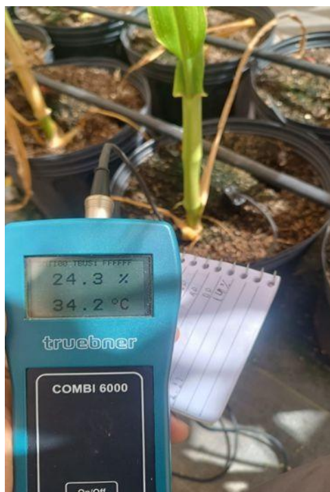
Figura 2. Aparelho portátil truebner COMBI 6000, utilizado no monitoramento da umidade de vasos.
