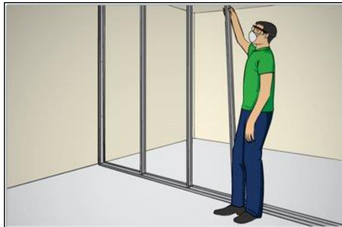
Figura 16 – Colocação dos montantes
