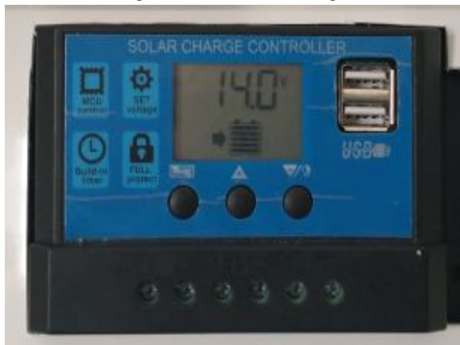
Figura 7: Controlador de carga.
