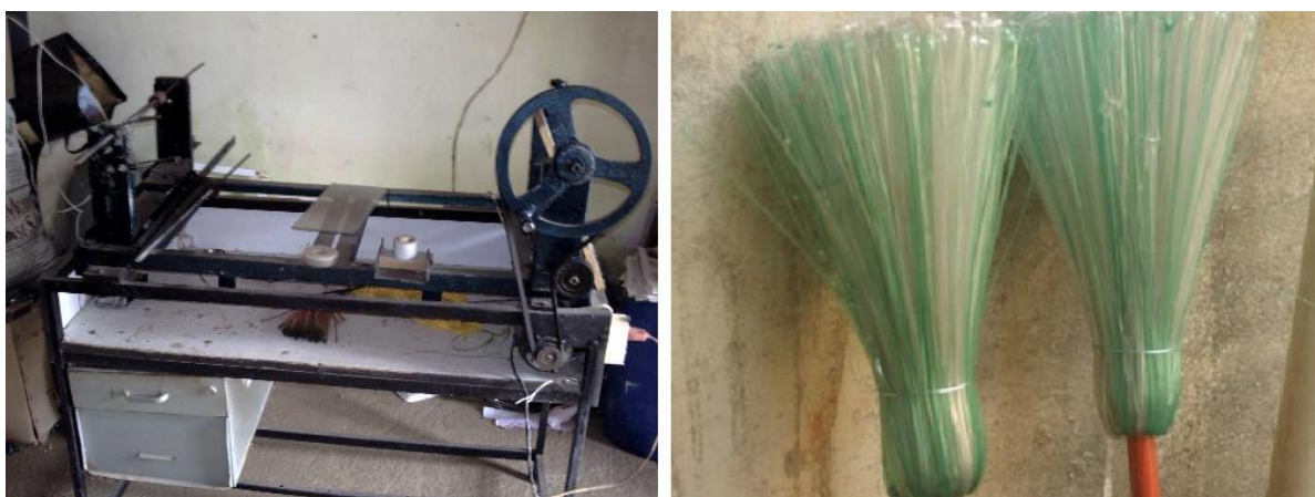
Figura 15 - Equipamento para beneficiamento das garrafas pet e produto final.
