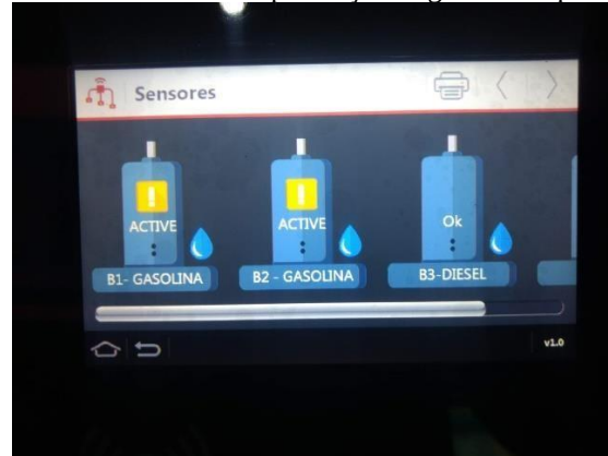
Figura 28: Sensor alertando a presença de água no tanque de gasolina
