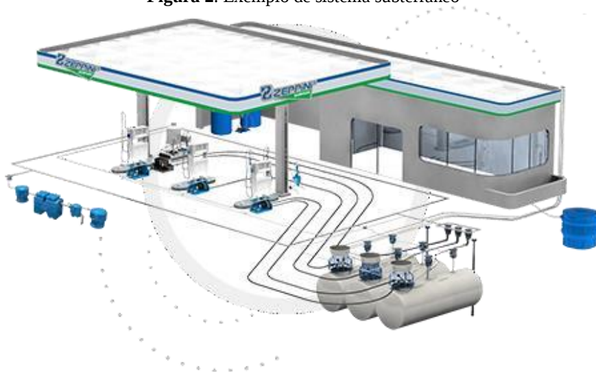
Figura 2: Exemplo de sistema subterrâneo
