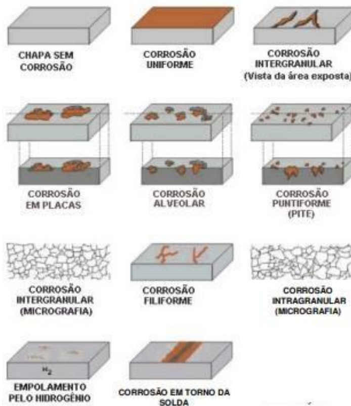
Figura 9: Exemplos de corrosão
