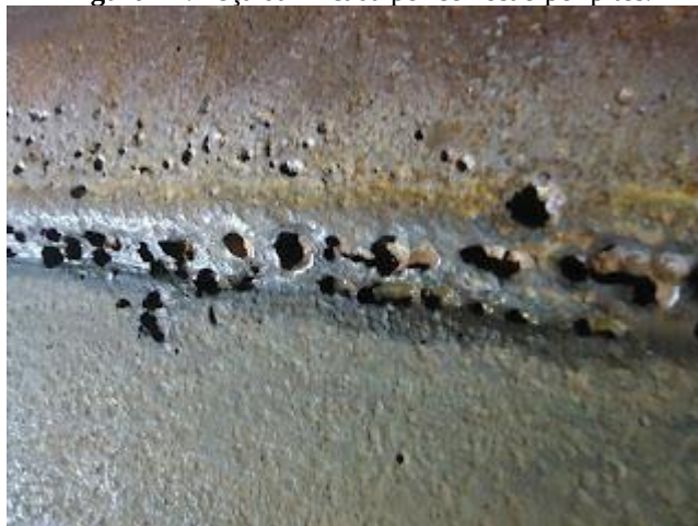
Figura 11: Peça danificada por corrosão por pites.
