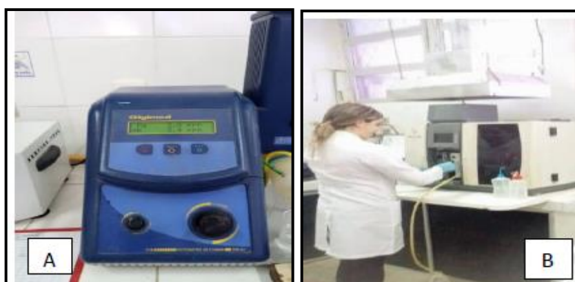
Figura 4. Determinação de sódio (Na) e potássio (K) por fotometria de emissão de chama (A) e determinação de Cálcio (Ca) e magnésio (Mg) por espectrofotometria de absorção atômica (B).
