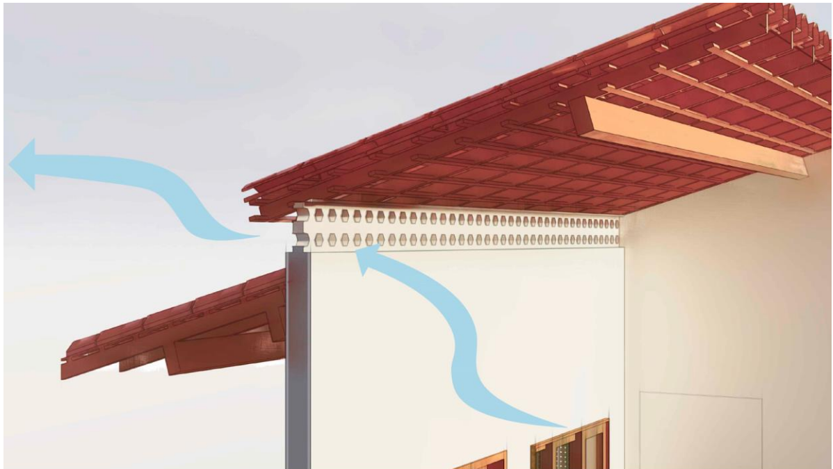
Figura 65 - Elemento vazado de solo-cimento.
