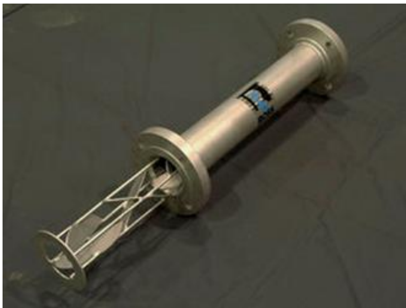
Figura 6 - Misturador estático dentro de um tubo com defletores.
