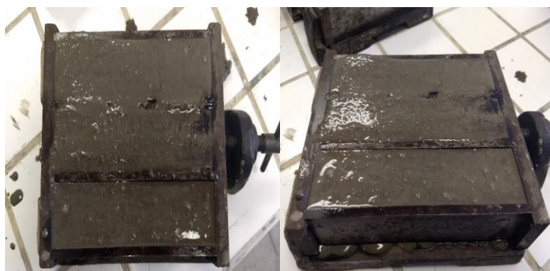
Figura 7 - Confeção dos corpos de provas
