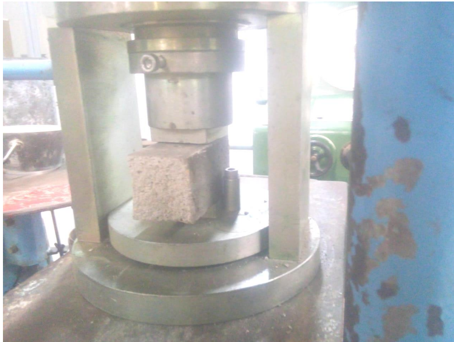
Figura 12 - Corpo de prova sendo ensaiado à compressão
