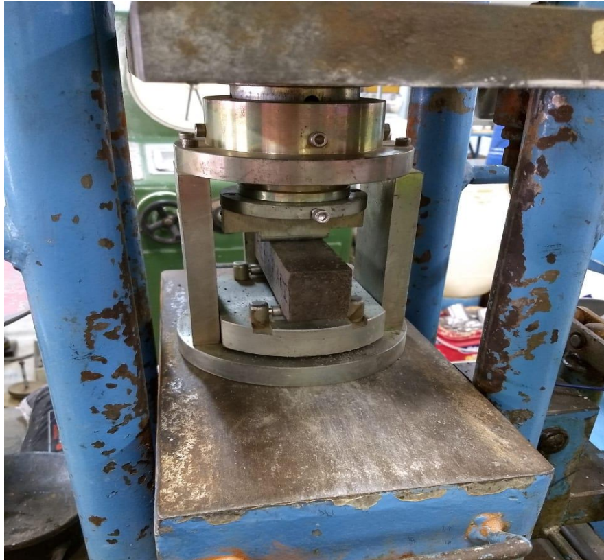
Figura 11 - Corpo de prova sendo durante realização do ensaio a flexo tração
