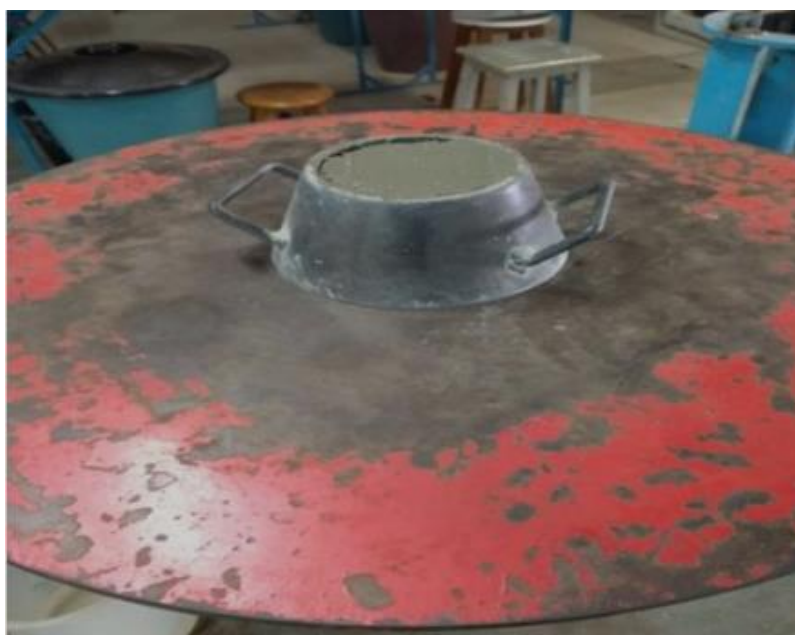
Figura 10 - Mesa de Consistência e molde metálico tronco - cônico
