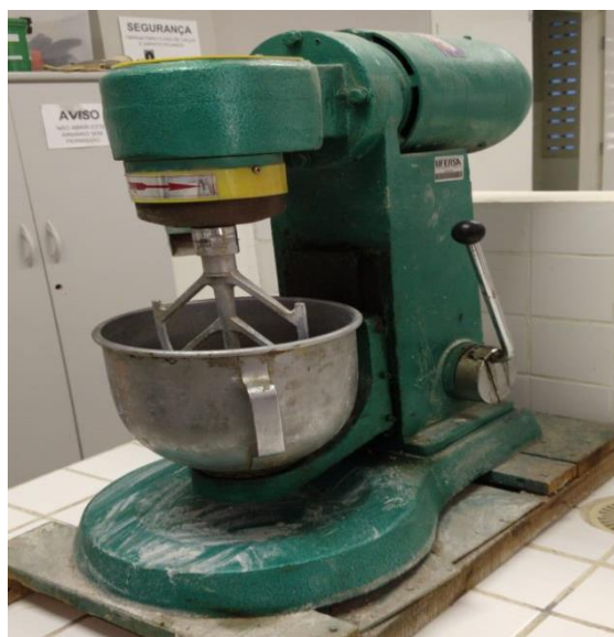
Figura 5 - Argamassadeira de cuba inoxidável
