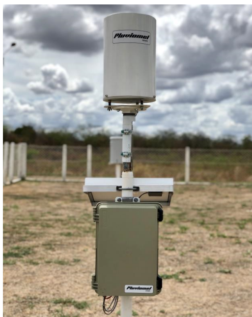
Figura 25: PLUVIOMET instalado em campo.
