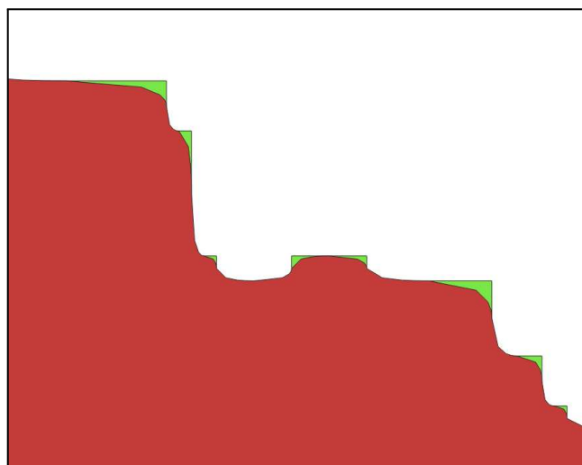
Figura 22 - Em vermelho bordas suavizadas pelo algoritmo "r.water.outlet" e em verde bordas ásperas, no QGIS
