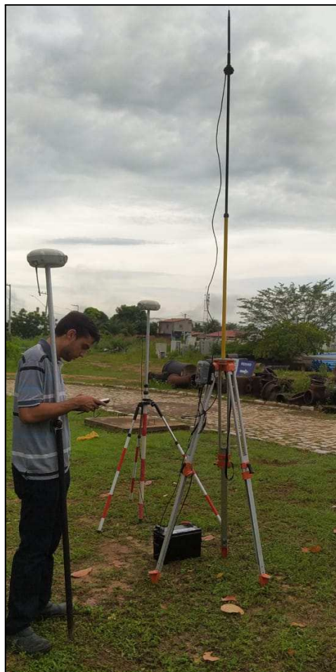
Figura 16 - Base RTK instalada, antes do início do levantamento altimétrico
