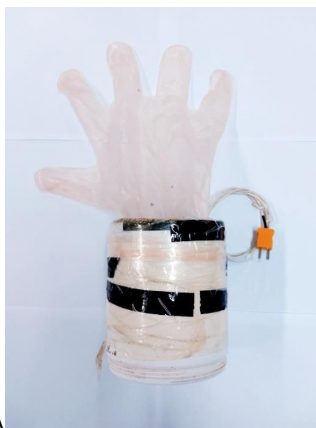
Figura 3 - Sensor tipo K conectado ao dispositivo facial (A) desenvolvido para mensuração da temperatura do ar expirado de bovinos.
