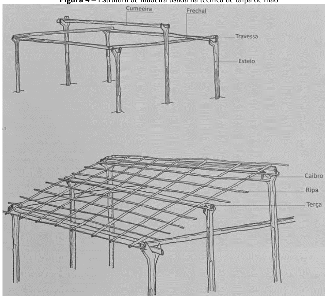
Figura 4 – Estrutura de madeira usada na técnica de taipa de mão
