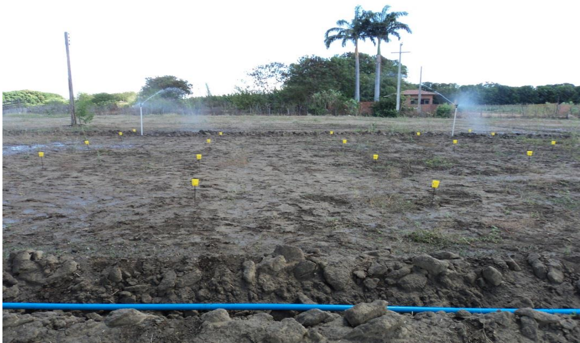
Figura 4: Avaliação de uniformidade de distribuição no sistema de irrigação por aspersão.
