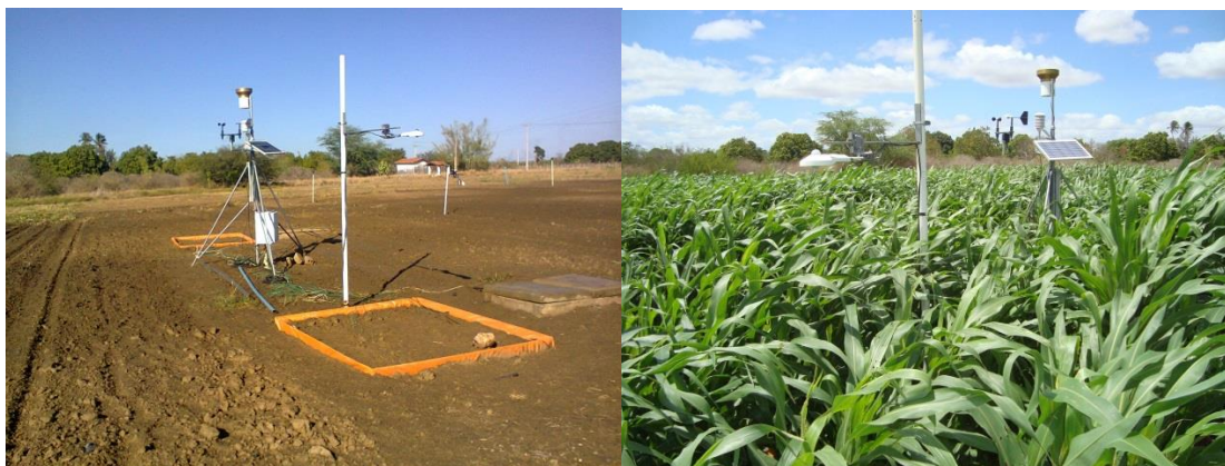
Figura 6: Estação meteorológica automática instalada na área experimental.
