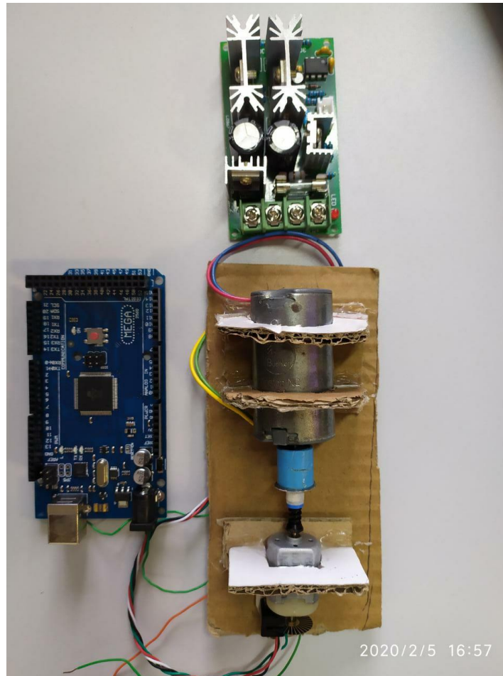
Figura 9:Esquema de Controle de velocidade para Motor CC utilizando PID.
