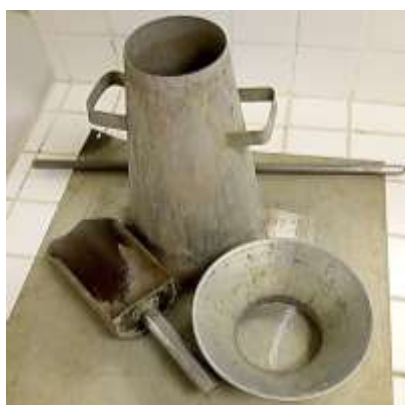
Figura 31 – Instrumentos do teste de abatimento Slump.
