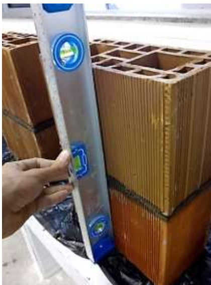
Figura 37 – Verificação da planicidade do prisma.
