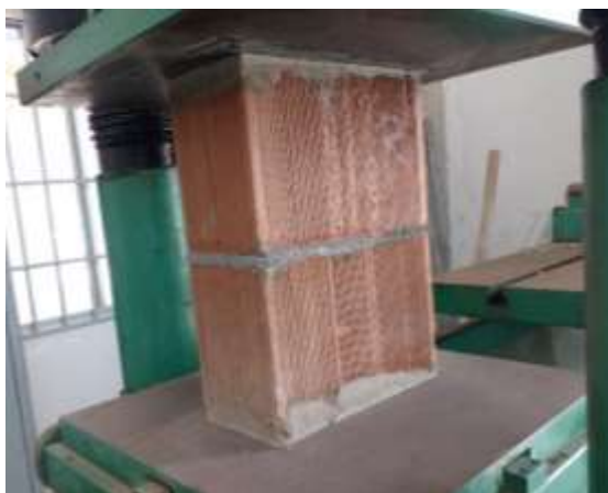
Figura 41 – Prisma posicionado em prensa para ensaio de compressão axial.
