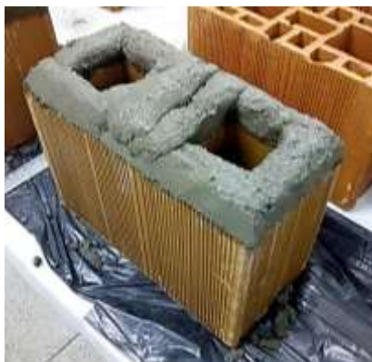
Figura 36 – Argamassa na face superior do bloco estrutural.
