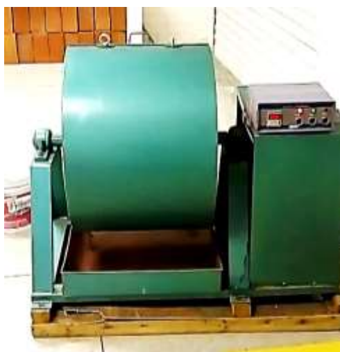
Figura 19 – Máquina de Abrasão Los Angeles.
