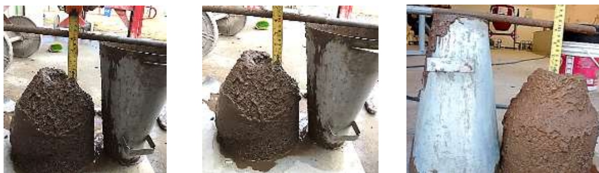
a) Traço de Referência; b) Traço de 15% de RCV; c) Traço de 30% de RCV.
