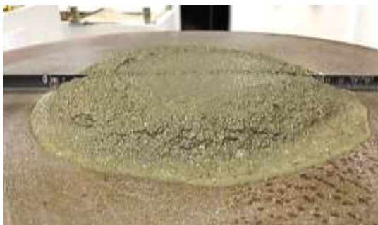
Figura 26 – Ensaio de consistência da argamassa.
