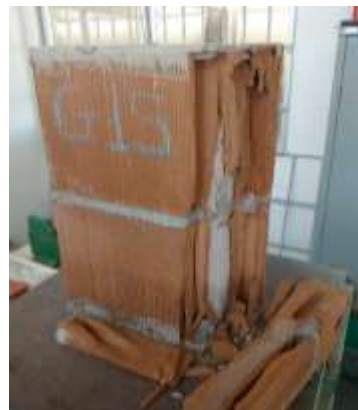
(b) ruptura causada pelo acúmulo de tensões em uma das laterais.
