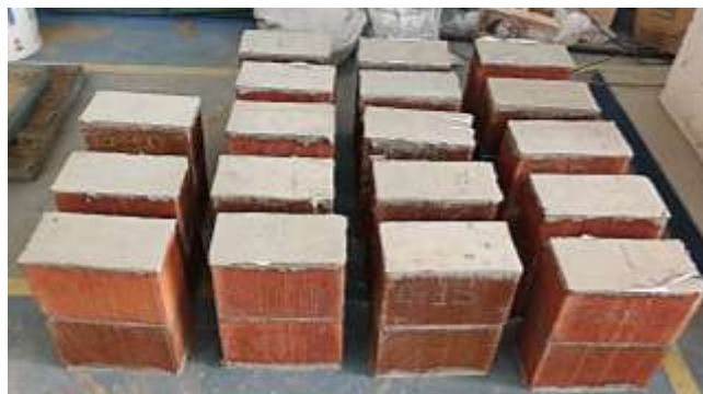
Figura 40 – Prismas após a realização do capeamento.
