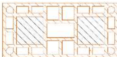
Figura 43 – Ganho de secção no prisma grauteado.
