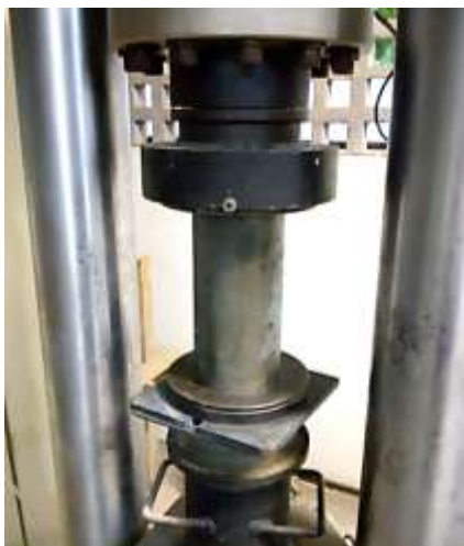
Figura 34 – Corpo-de-prova posicionado para ensaio de compressão axial.
