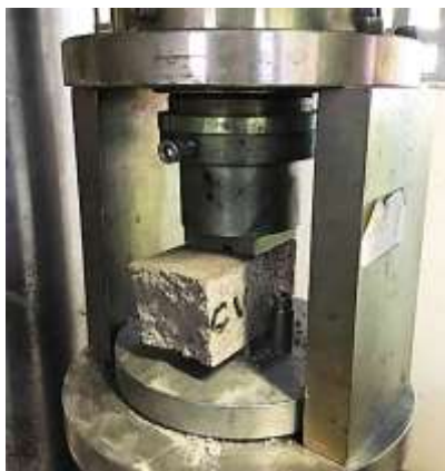
Figura 29 – corpo-de-prova de argamassa posicionado na prensa.
