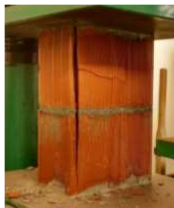
Figura 46 – Modelo de ruptura dos prismas de 30% RCV.
