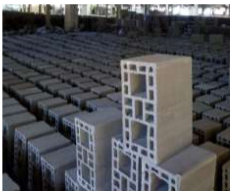
Figura 6 – Blocos cerâmicos empilhados para secagem natural após extrusão.
