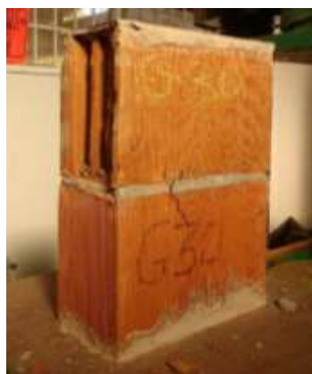
Figura 46 – Modelo de ruptura dos prismas de 30% RCV.
