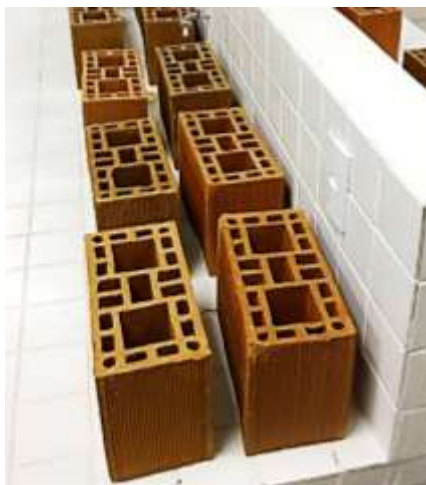
Figura 35 – Blocos cerâmicos posicionados para preparo dos prismas.
