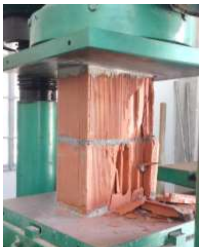
Figura 44 – Mecanismo de ruptura do prisma de referência.
