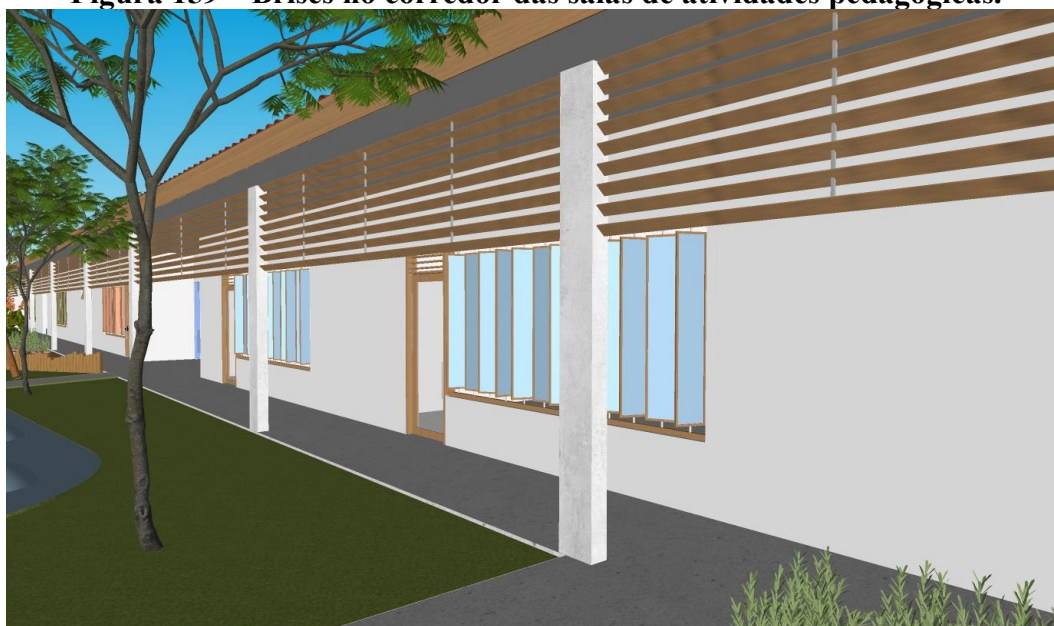
Figura 159 – Brises no corredor das salas de atividades pedagógicas.
